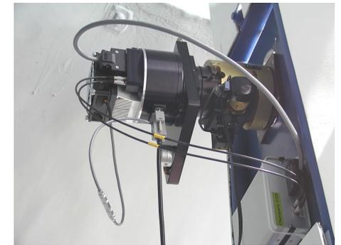
*Caméra Chungara KAF 6303E montée, avec roue à filtres, correcteur 3" et porte-oculaire piloté*
