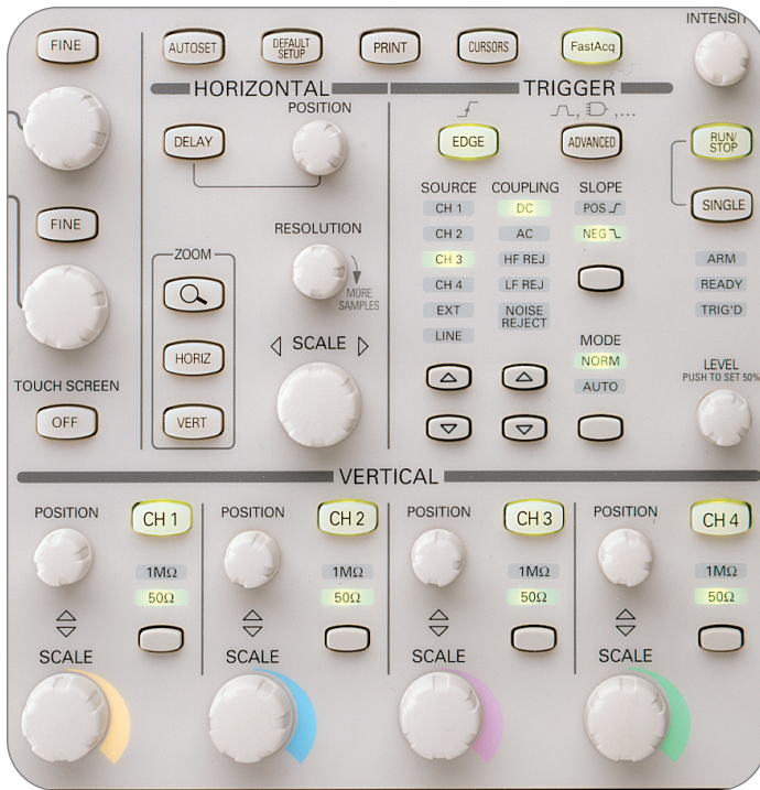
► Figure 22. Commandes de la face avant d'un oscilloscope.
