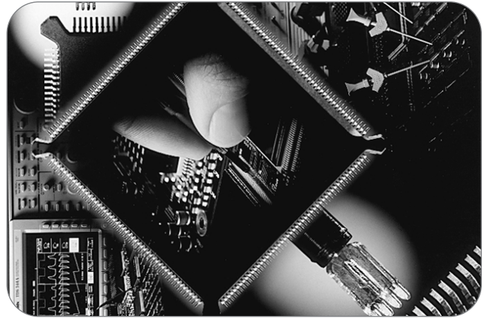
► Figure 45. Les adaptateurs SureFoot™ des séries SF200A et SF500 de Tektronix se caractérisent par un embout de faible longueur permettant d'établir une connexion fiable avec une broche particulière d'un circuit intégré.
