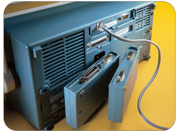
► Figure 55. L'oscilloscope TDS3000 offre toute une gamme d'interfaces de communication : port parallèle Centronics standard, et modules Ethernet/RS-232, GPIB/RS-232 et VGA/RS-232 optionnels.
