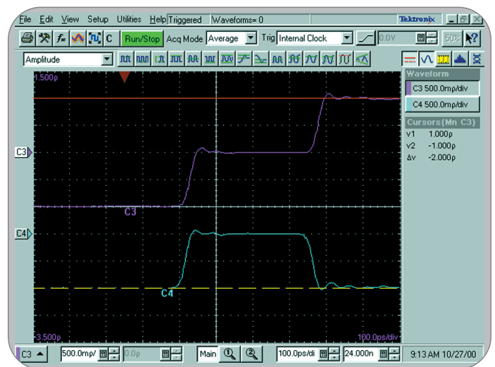
► Figure 21. Ecran de réflectométrie temporelle (TDR) d'un oscilloscope à échantillonnage numérique TDS8000 équipé du module d'échantillonnage à 20 GHz 80E04.
