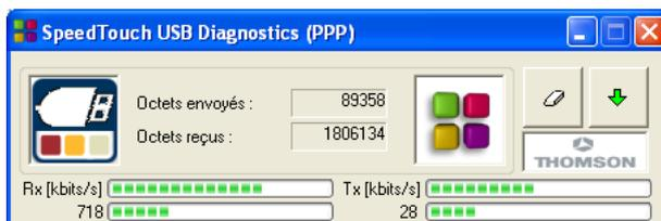
**Remarque** Dans l'exemple, la fenêtre Diagnostics s'applique à une installation PPP (PPPoA ou PPPoE). Dans le cas d'une installation de type RFC1483, la barre de titre indiquera RFC1483.
