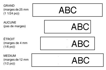
Après l'impression d'une étiquette avec le réglage de marge **AUCUNE** (pas de marge), maintenez enfoncée, puis appuyez une fois sur pour faire avancer le ruban avant de le couper en appuyent sur le levier de la coupeuse de ruban. Si vous n'effectuez pas une avance de ruban avant de couper celui-ci, il se peut que le texte de votre message soit coupé.
