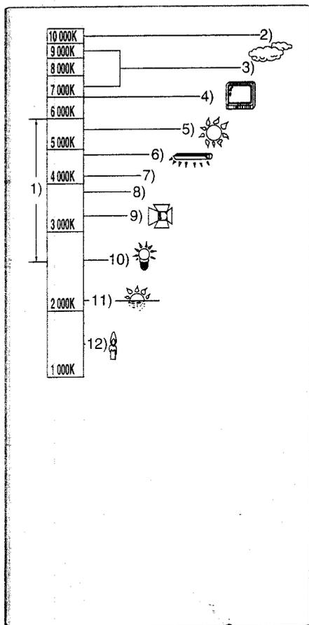
En dehors de la plage effective de réglage automatique de la balance des blancs, l'image deviendra bleuâtre ou rougeâtre. Même pour des valeurs comprises dans la plage effective de réglage de la balance des blancs, cette option pourrait ne pas fonctionner d'une manière appropriée s'il y a plus d'une source de lumière. Dans ce cas, il faut régler manuellement la balance des blancs.
