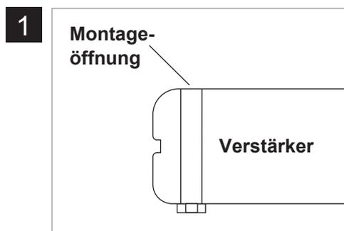
An jeder Ecke des Geräts befinden sich Montageöffnungen zur Befestigung am Fahrzeug. Bitte achten Sie beim Montieren darauf, dass die Oberfläche des Verstärkers nicht mit den Werkzeugen beschädigt oder zerkratzt wird.
