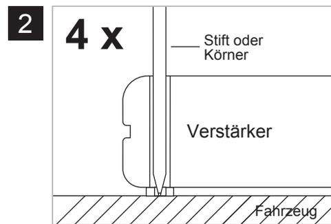
Halten Sie den Verstärker an die gewünschte Einbaustelle im Fahrzeug. Markieren Sie die vier Bohrlöcher mit einem geeigneten Stift oder Körner durch die Montageöffnungen.
