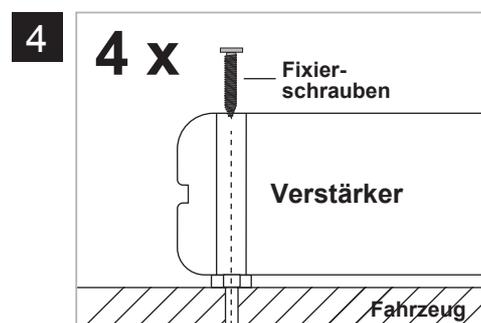
Halten Sie dann den Verstärker wieder an die zuvor gewählte Position und verschrauben den Verstärker mit den zuvor gebohrten Bohrlöchern am Fahrzeug.
