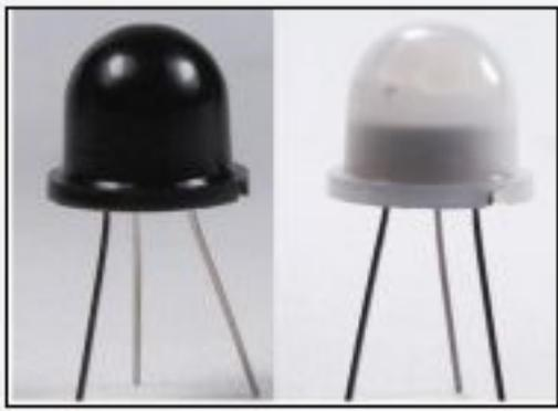
**透镜说明:** 广泛应用于人体感应开关, 报警器, 红外测温仪和红外成像等方面。可为用户提供不同感应角度, 感应距离, 尺寸, 测试比。菲涅尔透镜作用: 一是聚焦作用; 二是将探测区域内分为若干个明区和暗区, 使进入探测区域的移动物体能以温度变化的形式在 PIR (被动红外线探测器) 上产生变化热释红外信号。
